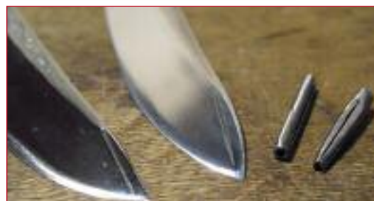
Варианты реализации ножа-распарывателя посредством присоединения к клинку насадки — «отупителя» (идея и работа автора)
