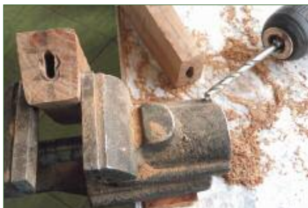
Выполнение глухих гнезд в заготовках под рукояти для установки черенков клинков
