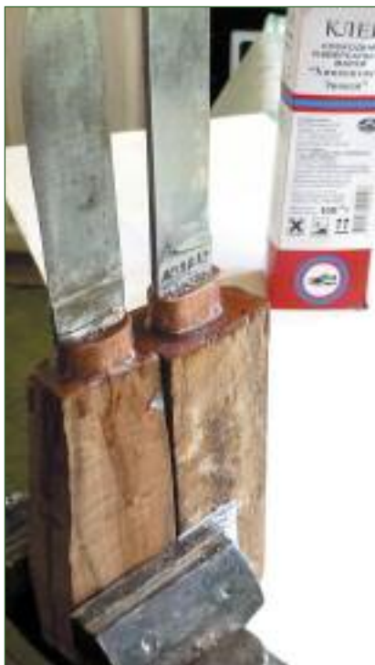
На фото слева — после установки клинков и гард на заготовки для рукоятей. Период затвердевания эпоксидного клея
