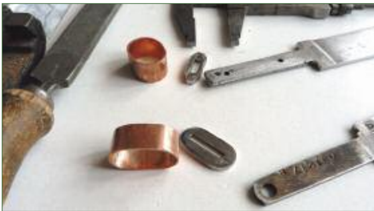
Подготовка обжимных колец на начало рукоятей (обоймиц)
