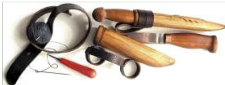
Кожаная антабка подвески ножа и ее установка на ножны
