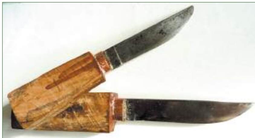
На фото слева — после установки клинков и гард на заготовки для рукоятей. Период затвердевания эпоксидного клея
