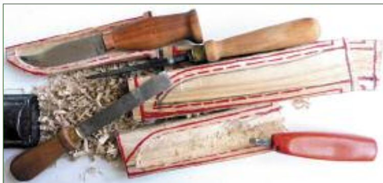
На фото сверху — разметка и устройство полостей в половинках заготовок для ножен
