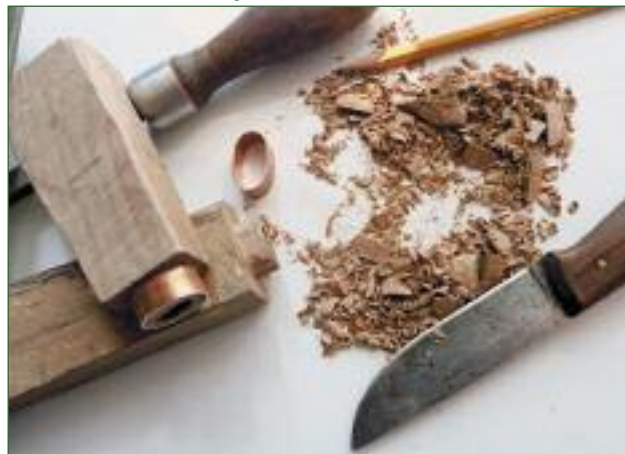
Подготовка мест для установки обжимных колец
