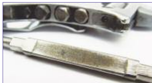
Модуль разводного ключа имеет специальные посадочные места для размещения отверточных бит и трехгранного алмазного надфиля (выполняющего также функцию подпружиненного фиксатора). Все компактно и предельно функционально
