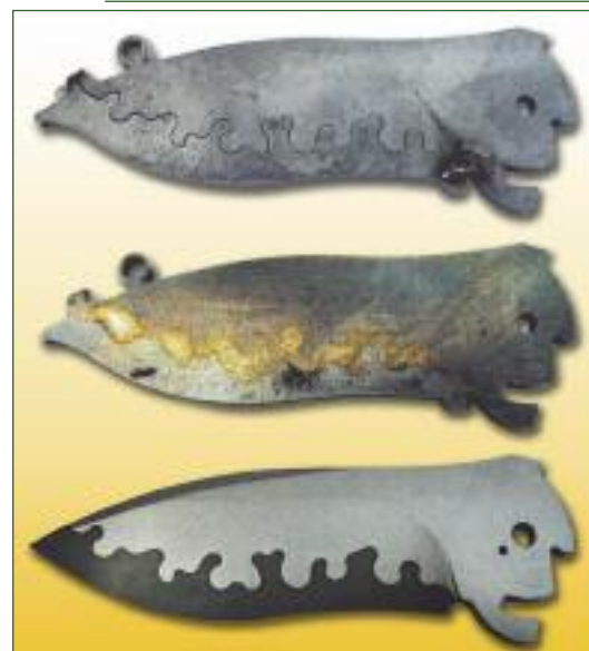
Технологические стадии производства клинка сверху вниз: сборка; пайка; шлифовка
