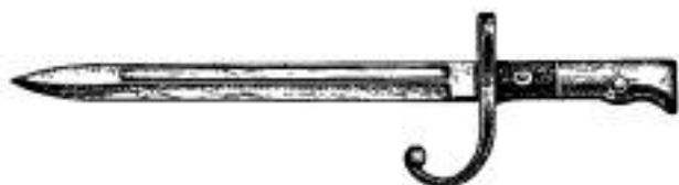
Рис. 280. Штык 8 мм магазинной винтовки системы Мурата обр. 1887 г. (Япония)
