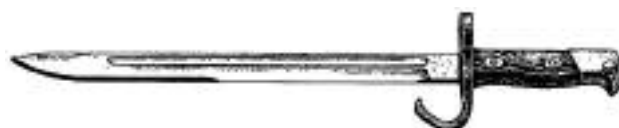
Рис. 281. Штык 6,5 мм магазинной винтовки системы Арисака обр. 1897 г. (Япония)
