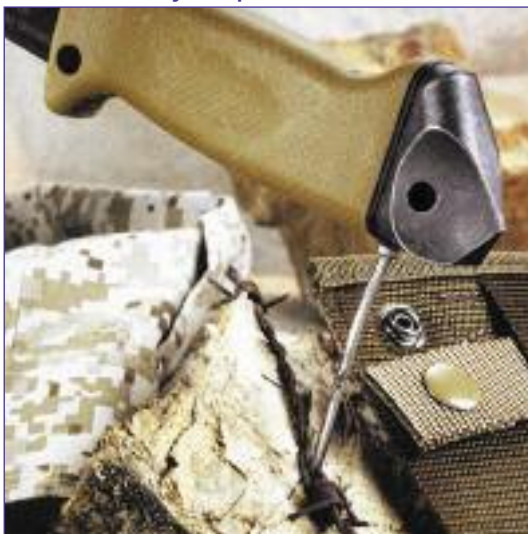
Навершие ножа может служить в качестве молотка, но для безопасного забивания гвоздей «острый предмет» следует держать в ножнах...
