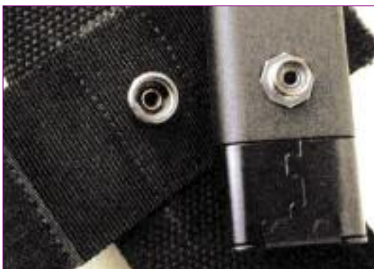
Устья ножен (вверху) имеют крепление к портупейному ремню, а наконечник (внизу) оформлен как кусачки для проволоки
