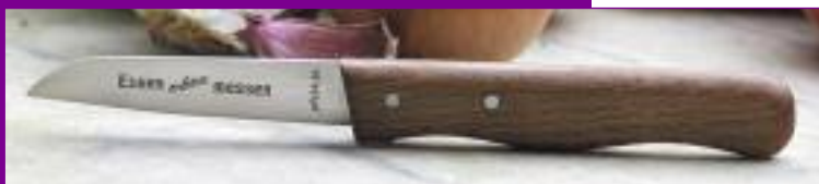
Типичный нож для чистки овощей с 70-мм клинком и загнутым вниз острием
