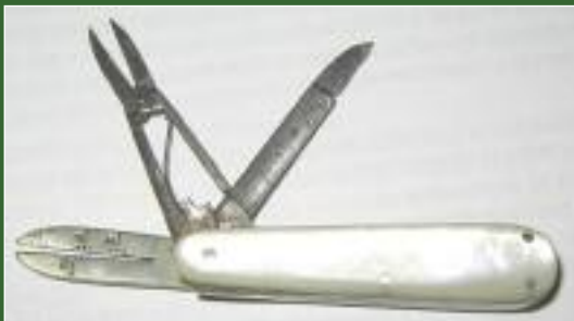
Мультиинструмент с калибром для струн и инструментами по уходу за ногтями
