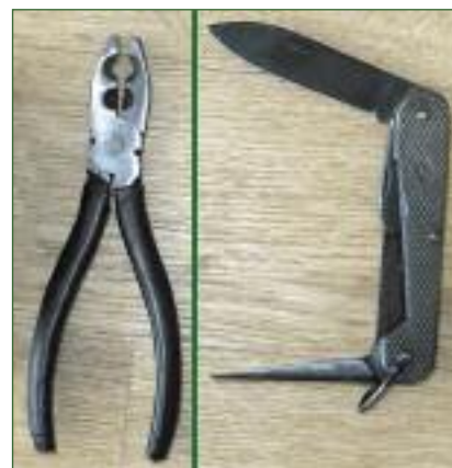
Инструменты, входящие в комплект отечественной сумки минера-подрывника (СМП): комбинированный обжим капсюля-детонатора №8 в форме плоскогубцев и саперный складной нож
