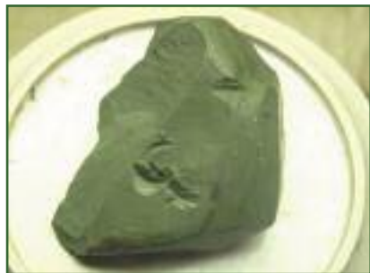
Паста ГОИ на основе оксида хрома — самая распространенная полировочная паста
