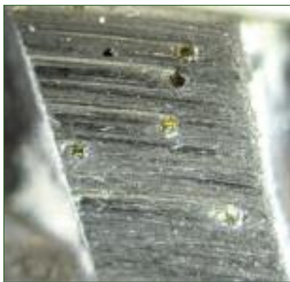
Увеличенный фрагмент торца абразивного диска с вкраплениями искусственных алмазов
