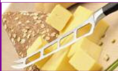
Типичные ножи для нарезания сыра с зубчатой режущей кромкой и отверстиями в клинке. В зависимости от плотности сыра используется определенная форма режущей кромки
