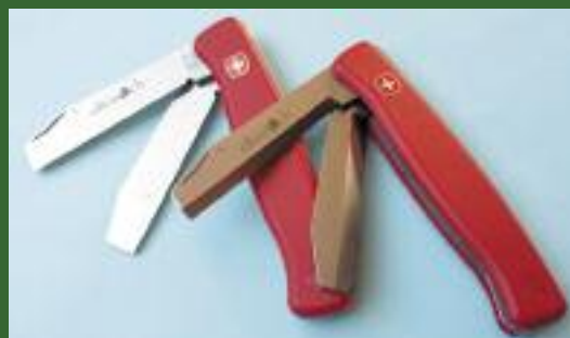
Ножи Wenger Ranger oboïste с клинками, заточенными для пользователя-левши (на фото слева) и правши (справа)
