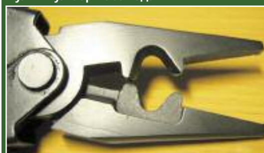
Вверху — пассатижи Gerber Multi-Plier 600 DET с инструментом для обжимки капсюлей-детонаторов; внизу — подпружиненный фиксатор инструментов
