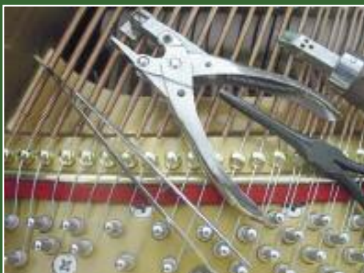
Фортепианные друкцанги — узкоспециализированный инструмент
