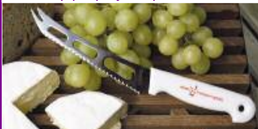
Типичные ножи для нарезания сыра с зубчатой режущей кромкой и отверстиями в клинке. В зависимости от плотности сыра используется определенная форма режущей кромки
