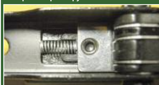
Вверху — пассатижи Gerber Multi-Plier 600 DET с инструментом для обжимки капсюлей-детонаторов; внизу — подпружиненный фиксатор инструментов
