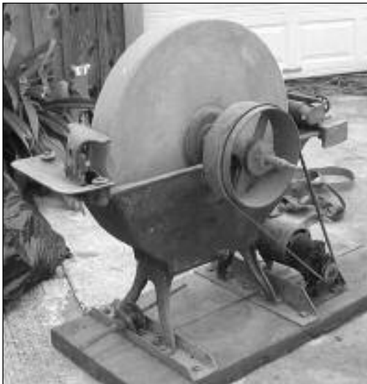
Точильно-шлифовальный станок с абразивным кругом большого диаметра для мокрой шлифовки, с подручником для опоры затачиваемого инструмента и электроприводом, начало XX в.
