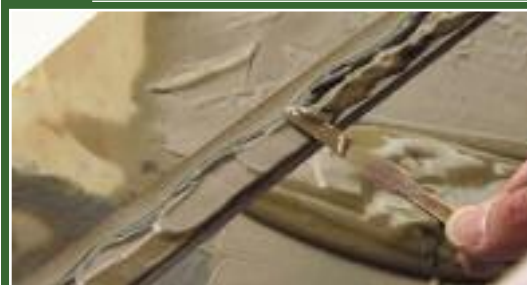
Нанесение глиняного состава на полосу клинка для последующей закалки. Хорошо видны контуры будущего хамона
