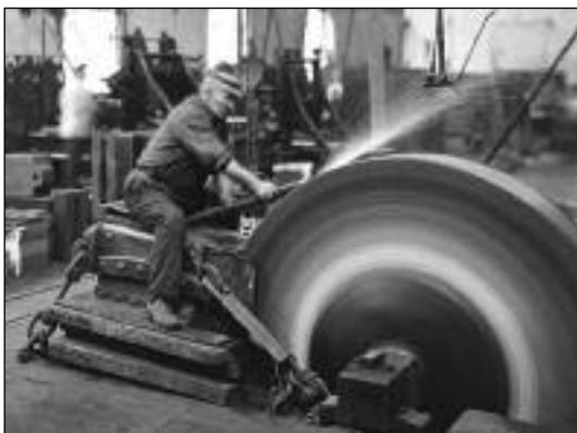
Типичное оснащение шлифовального цеха конца XIX — начала XX вв., Англия. На переднем плане изображен шлифовальный станок с кругом диаметром более 2-х метров! Как видно, никаких особых систем безопасности для шлифовальщика не предусмотрено
