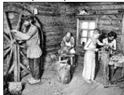
Шлифовально-полировальный станок в мастерской по производству ножниц в с. Павлово, 1890-е гг. Ручной ременной привод, на заднем плане стоит несколько сменных кругов и все со шпинделями, чтобы не балансировать круг после переустановки. Круг не снимается со шпинделя до полного износа. Активно эксплуатируется детский труд, отсутствует какая-либо вентиляция помещения
