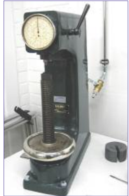
Стационарный механический пресс (твердомер) фирмы Valmet, позволяющий производить измерения по шкалам Роквелла и Бринелля
