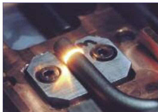
Один из самых современных способов нагрева детали из углеродистой стали — при помощи лазерного диода для последующей поверхностной закалки. На фото — промышленный лазер мощностью 2 кВт. Точность нагрева в пределах \pm 5^\circ\text{C} , не зависящую от конфигурации детали, обеспечивает бесконтактный пирометр
