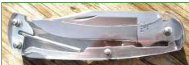
Наглядная демонстрация работы замка Buck-Lock на примере «прозрачной» модели ножа Buck 110 Folding Hunter
