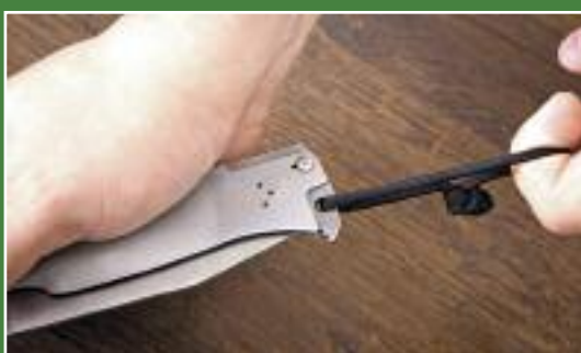
Чтобы расфиксировать нож с замком Ram Safe Lock, необходимо оттянуть ригельную пластину, потянув за темляк
