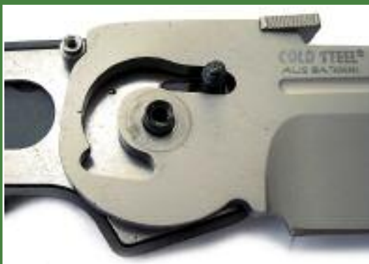
Фото слева и сверху: положение штифта фиксатора Ultra-Lock в фигурном пазу клинка при разложенном и сложенном положениях ножа Cold Steel AK-47
