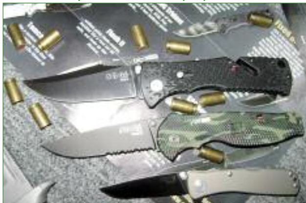
Интерпретации ригельного замка от SOG: сверху — модель Trident, ниже — Flash II. Отчетливо видны внешние отличия привода механизма расфиксации
