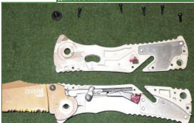
Внизу — устройство замка Arc-Actuator модели SOG Trident
