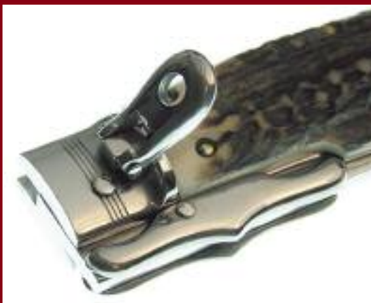
Многие модели автоматических стилетов и ножей оснащены так называемой свинг-гардой — шарнирной крестовиной, также складывающейся при сложении клинка
