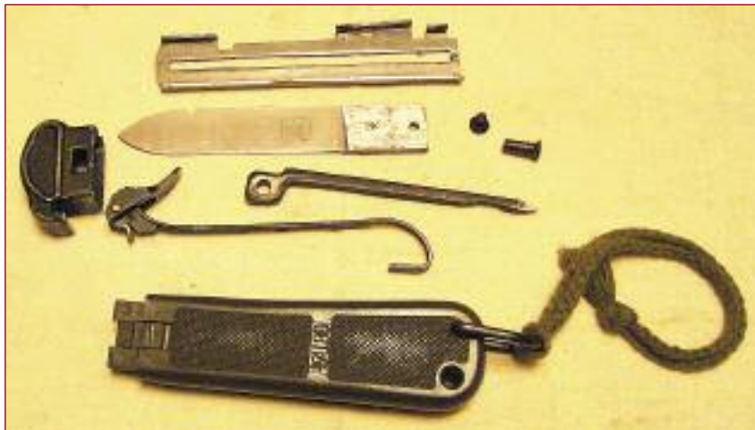
Германский «инерционник» Kappmesser M1937 (ранняя неразборная модель) и его внутреннее устройство (на примере современной версии LL80)
