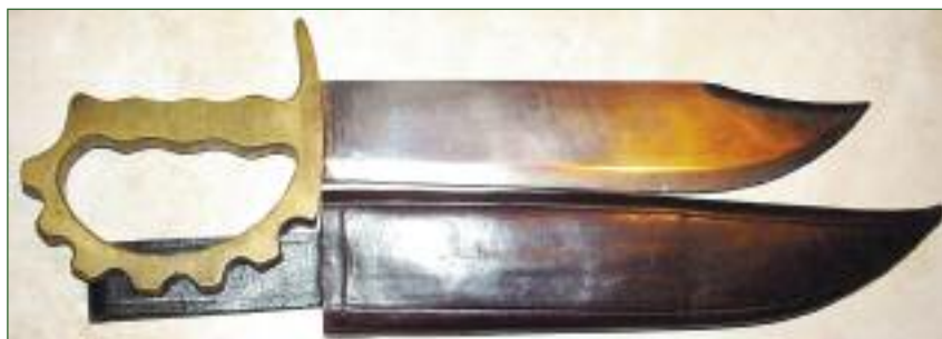
Пример одной из множества модификаций боевых ножей, производимых в Австралии и Новой Зеландии для армий союзников в годы Второй мировой войны. Отличительный признак таких ножей — развитая литая гарда (алюминиевая или латунная) с кастетными шипами
