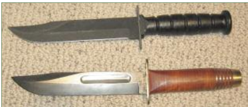
Вверху — боевой нож морпехов MkII (USMC) производства KA-BAR с рукояткой из черной фибры и анодированным клинком; внизу — ранний MkII производства Camillus (рукоять — новодел)
