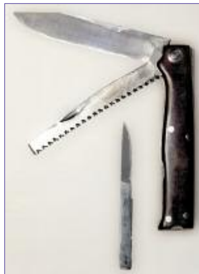
Справа — нож «для лесных прогулок» с дополнительным извлекаемым клинком (скальпелем)
