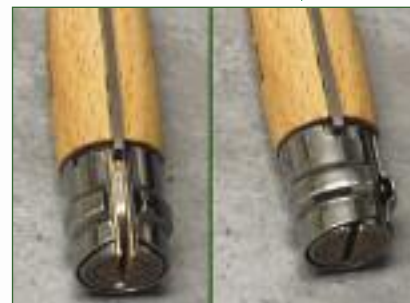
Открытое и закрытое положения замка типа Viroblock на ноже Orinel со сложенным клинком
