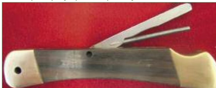
Внизу: элементы конструкции фиксатора lock-back второй версии: пружина одним плечом запрессована в коромысло, вторым плечом при сборке упирается в проставку
