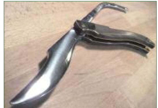
Современная реплика старой «беззамковой» навахи с удлиненным хвостовиком клинка
