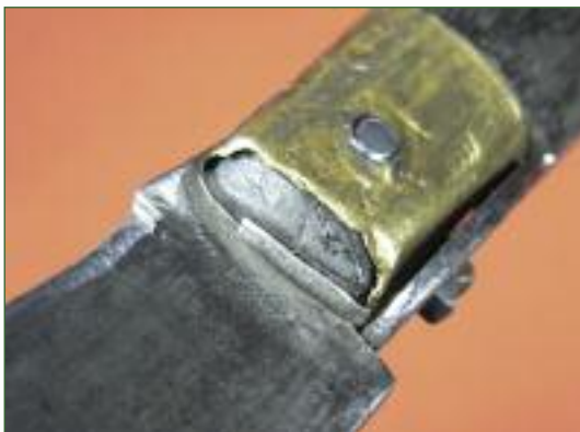
Работа замочного механизма типа semi-lock
