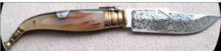
Наваха с замком, управляемым посредством рычага (так называемый фиксатор басков)
