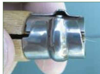
Открытое и закрытое положения замка типа Viroblock на ноже Orinel со сложенным клинком
