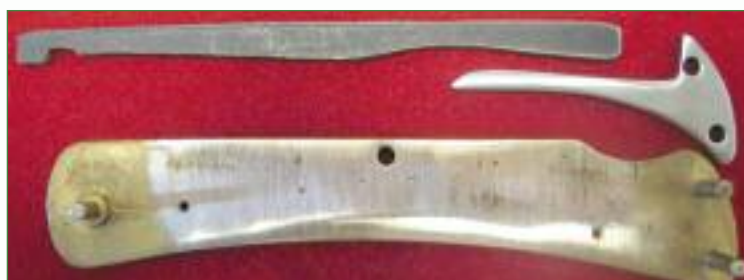
Вверху: элементы конструкции фиксатора lock-back первой версии: коромысло и пружина, совмещенная с проставкой в виде единой сложной детали
