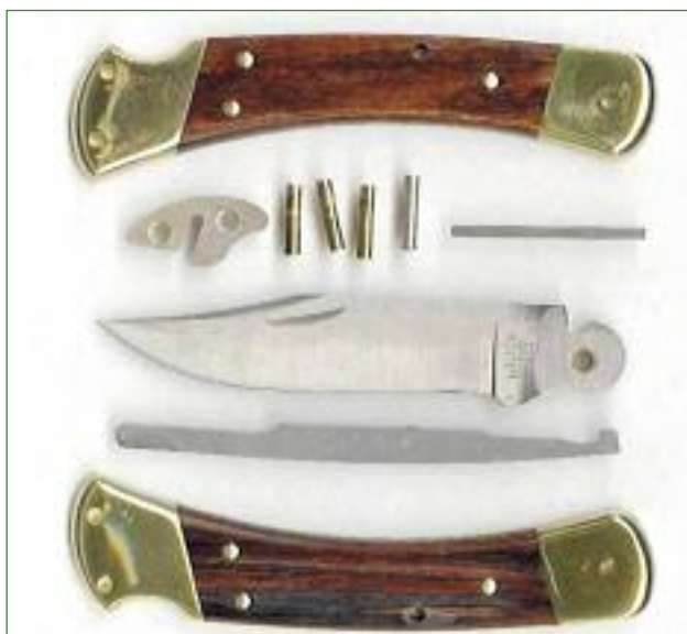
Вверху: элементы конструкции фиксатора lock-back третьей версии: коромысло и пружина являются отдельными деталями, а проставка интегрирована с одной из плашек (правой).
