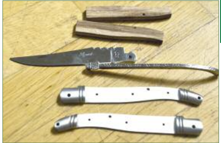
Нож Laguiole: общий вид и нож в разобранном виде. Хорошо видны основные замочные детали: плоская пружина и сегментный вырез хвостовика клинка
