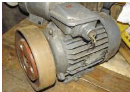
Низкооборотистый двигатель с плоским шкивом — основа будущего ленточного гриндера. Цена «вопроса» самодельного гриндера — в несколько раз дешевле промышленного станка
