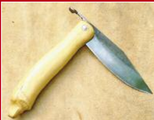
Современная реплика дешевого фрикционного складного ножа
