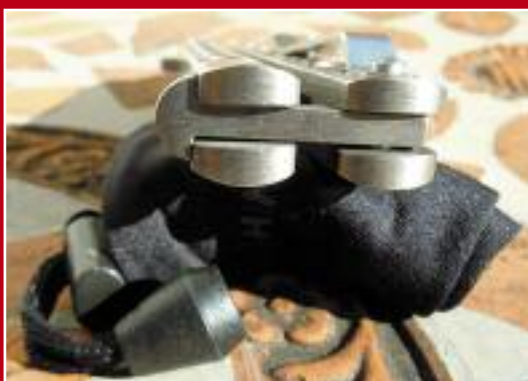
Стандартная рычажная защелка рукояти балисонга (модель Benchmade 31 Balisong)
