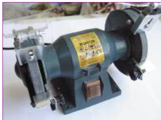
Дешевый маломощный станок китайского производства. Его стихия — заточка сверл и небольших режущих инструментов; при замене штатного круга — финишная полировка
