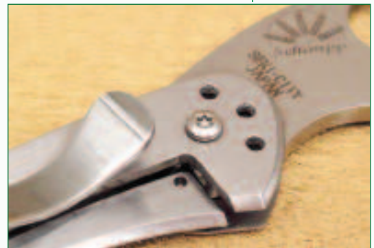
Замок Integral-lock с шариковой защелкой ball denent на примере ножа Spyderco Balance SS
