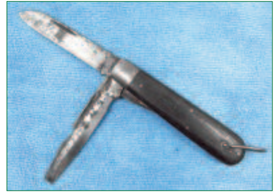
Двухпредметный «нож электрика» ( Electrician Knife ) TL-29 с замком Liner-lock производства компании Camillus Cutlery времен Второй мировой войны
