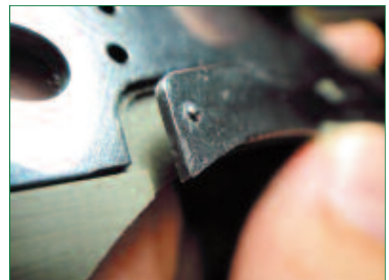
Внизу: защелка ball denent — шарик, запрессованный в запирающую пружину (лайнер) замка
