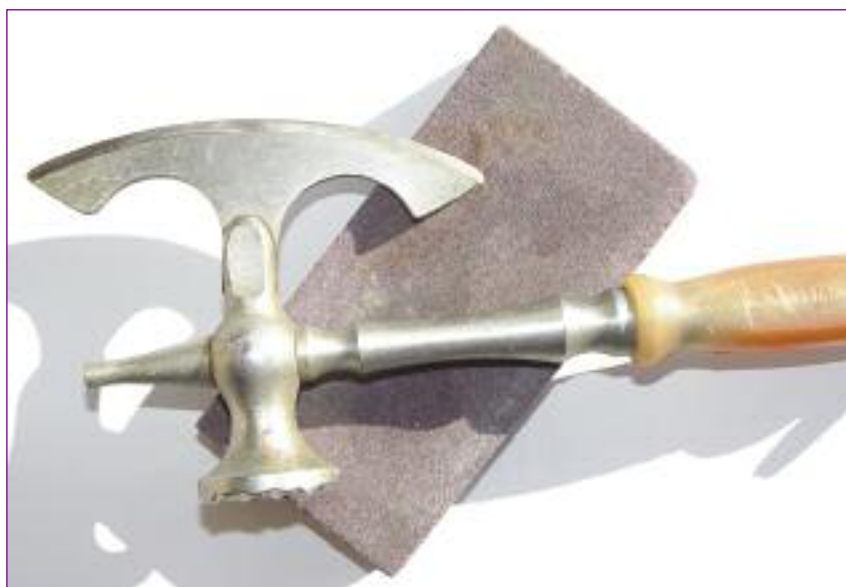
Крупнозернистый оселок отлично подходит для грубой предварительной заточки основательно затупленного инструмента, например, кухонного топорика
