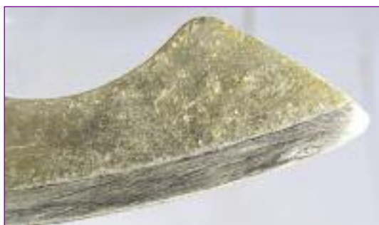
Крупнозернистый оселок отлично подходит для грубой предварительной заточки основательно затупленного инструмента, например, кухонного топорика
