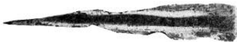
Фиг. 40. Макроструктура лезвия косы
