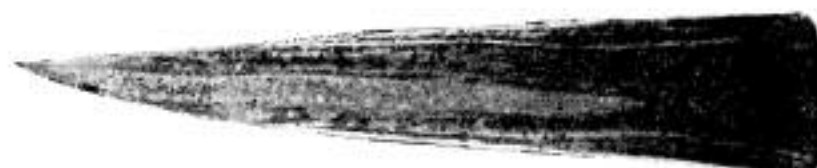
Фиг. 43. Макроструктура лезвия топора
