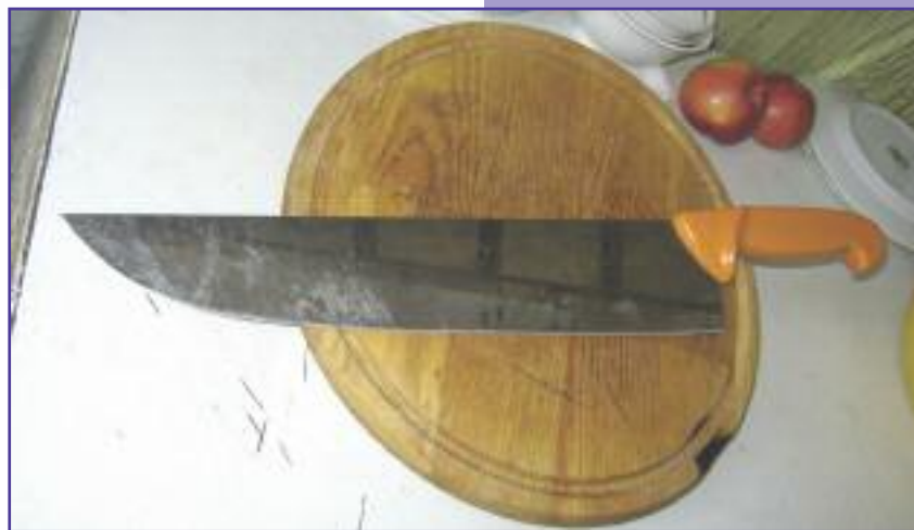
«Секач» — на клинке видны следы от рубки в области ударного центра
