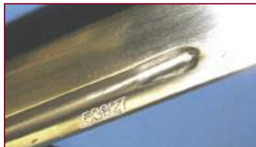
Клейма и номер, выбитые на подделке
