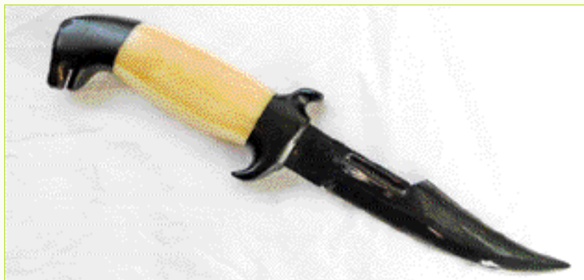
Клинок из стали У-8, рукоять из клыка моржа, голова медведя из черного текстолита. Изготовлен в 1950 году в экспедиции на дрейфующей льдине моим родственником, радистом Булатовым А. П. Твердость лезвия 57 единиц.
