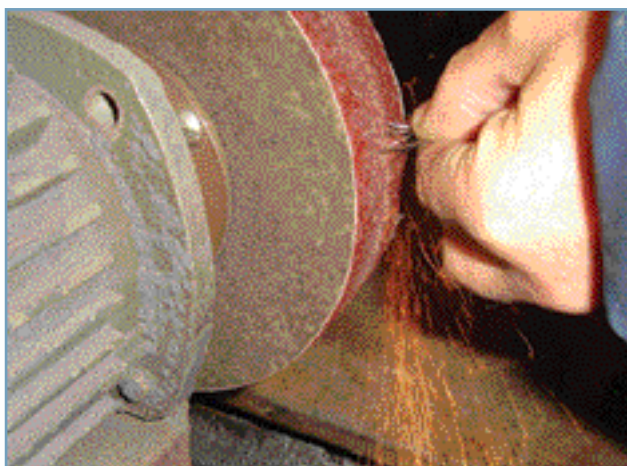
Рис 8. Проверка на искру
