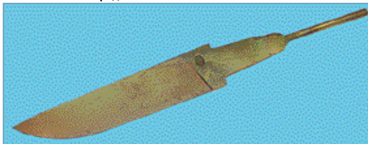
Рис. 27. Клинок после закалки
