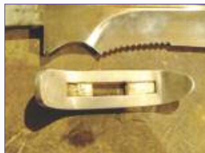
Фото 14, 15. Штихелем вырезаю потай под клинок (для большей жесткости)
