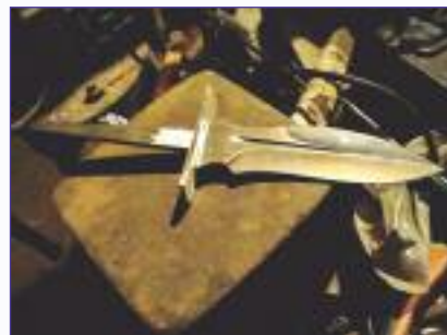
Фото 9. Выточив отверстие, насаживаю пластину на хвостовик
