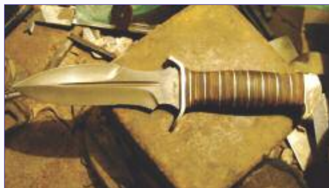
Фото 28. Обтачиваю лишнее серебро и придаю форму головке рукояти
