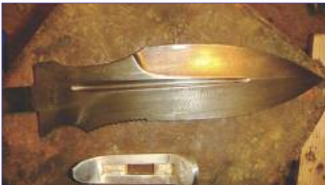
Фото 20, 21, 22. Протравливаю узор крученного дамаска, торцевой сварки (кузнец Красин Михаил)
