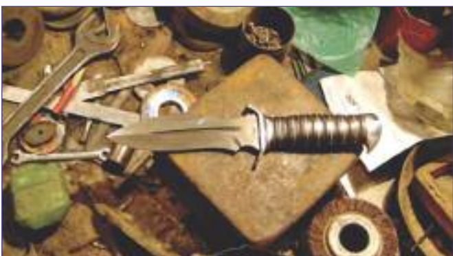
Фото 31, 32. Делаю углубление по коже для удобства хвата
