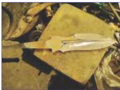
Фото 4. Делаю разметку дола и грубым камнем обтачиваю спуски под заточку (выборки)
