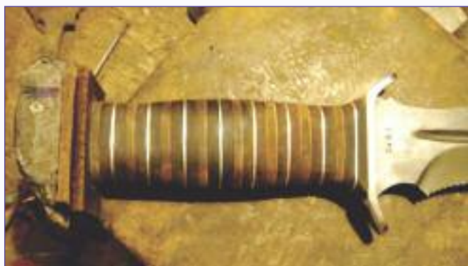
Фото 27. Начерно накручиваю поковку из серебра и стягиваю до отказа набор из кожи
