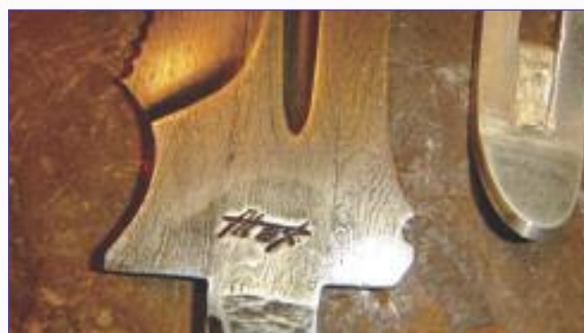
Фото 23. Ставлю свое клеймо и год изготовления
