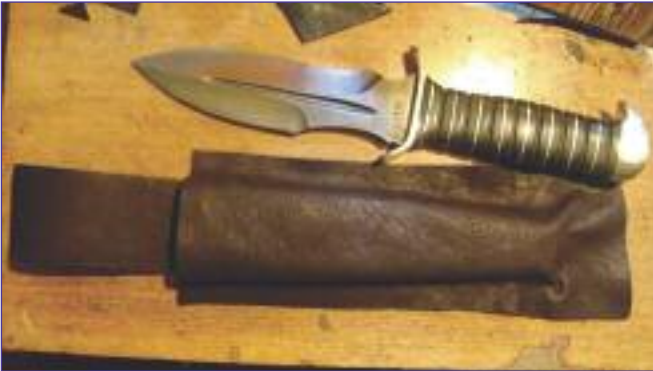
Фото 35. Делаю из плотной кожи выкройку под крепление и обшивку
