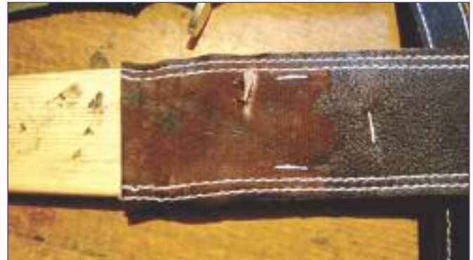
Фото 39, 40. Для надежности пробиваю степлером крепление к основанию ножен
