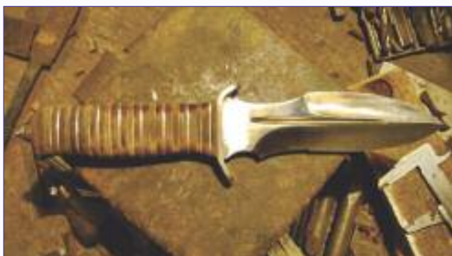
Фото 19. Начерно собираю сегменты на хвостовик и стягиваю гайкой, придаю форму рукояти
