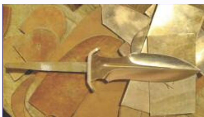
Фото 16. В качестве материала для рукояти применяю пресс-кожу и прокат серебра
