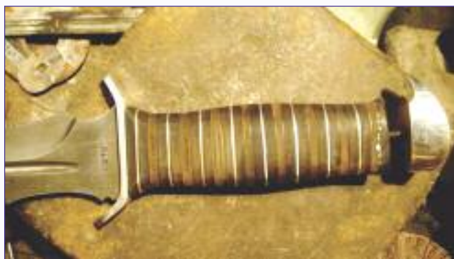
Фото 29. Проклеиваю все сегменты (клей ПВА) и стягиваю головкой, которая одновременно служит и гайкой
