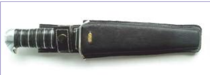
Фото 41. Собираю обшивку на основание и на хлястик ставлю кнопку, на ножны клеймо и готово!
