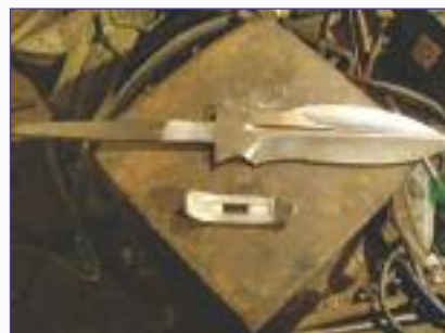
Фото 14, 15. Штихелем вырезаю потай под клинок (для большей жесткости)
