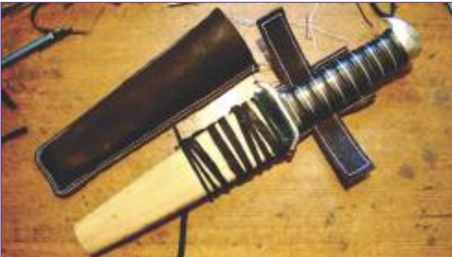
Фото 38. Хлястик для фиксации рукояти продеваю в отверстия креплений для ремня
