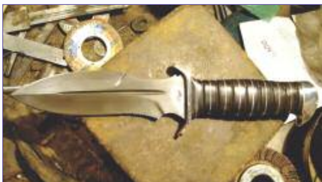
Фото 31, 32. Делаю углубление по коже для удобства хвата
