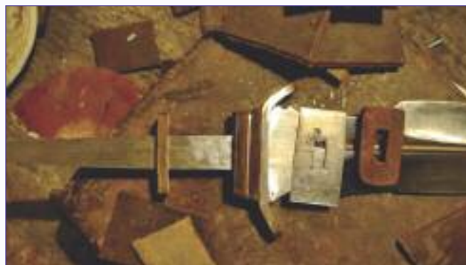
Фото 17 и 18. Нарезаю кожу и серебро сегментами и вырубаваю в сегментах отверстие под хвостовик
