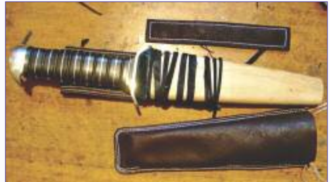
Фото 37. Крепление под ремень приклеиваю к дереву
