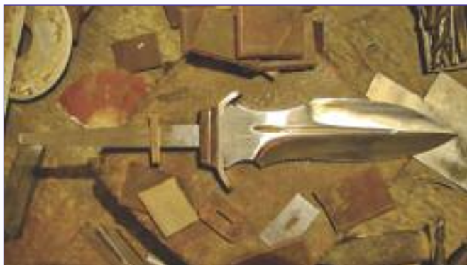
Фото 17 и 18. Нарезаю кожу и серебро сегментами и вырубаваю в сегментах отверстие под хвостовик
