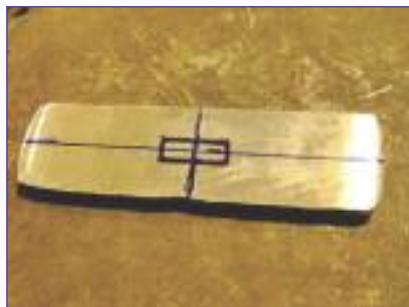
Фото 7, 8. На откованной пластине из серебра делаю разметку для отверстия под хвостовик
