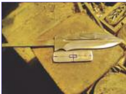
Фото 7, 8. На откованной пластине из серебра делаю разметку для отверстия под хвостовик
