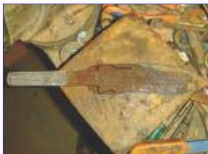
Фото 2. Обтачиваю контуры клинка
