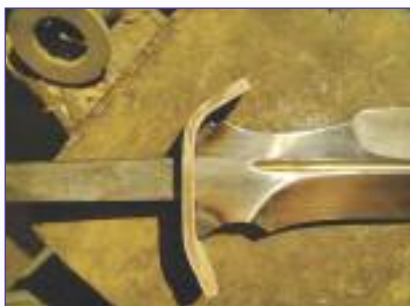
Фото 10, 11. На горячую выгибаю пластину
