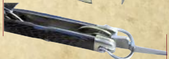
Модель ножа для юных скаутов «Детенышей», — оснащена фиксаторами предметов для большей безопасности подростка.
