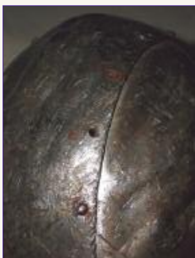
Пример срубленных и поврежденных заклепок, шлем требует ремонта
