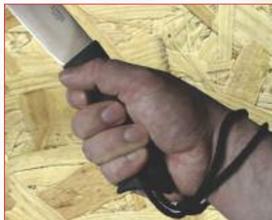
Специфическое расширение головки в виде рыбьего хвоста, гасящий отдачу резиноподобный материал и «пистолетная» рукоять позволяет использовать этот баронг и для рубки тропической растительности, и в качестве режущего инструмента
