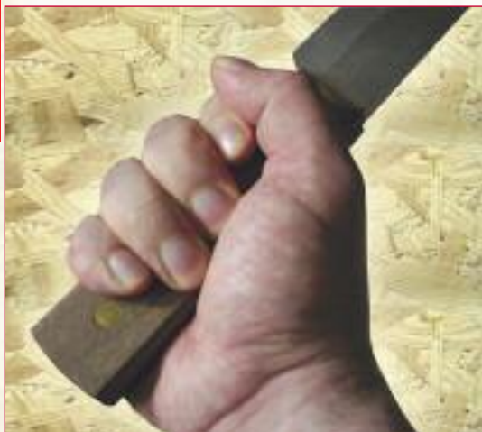
Силовой прямой захват горстью рукояти мачете при выполнении размашистых движений по рубке растительности
