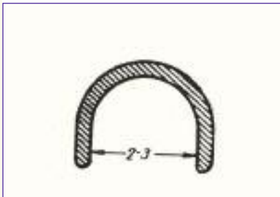
Поперечное сечение полотна царзика (увеличено)
