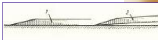
Положение прямой стамески на бруске во время точки: 1 — правильное (стамеска на бруске лежит плотно); 2 — неправильное
