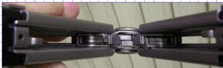
Пассатижи перемещаются по направляющим на спинках пластин рукояти
