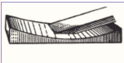
Заovalивание фаски на неправильном бруске или оселке
