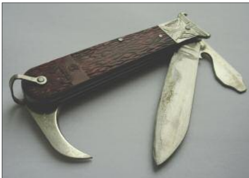
Обновление модельного ряда заводом «Сувенир» в середине 1980-х радости пользователям не принесло — переход на мягковатую нержавеющую сталь ухудшил функциональность ножей
