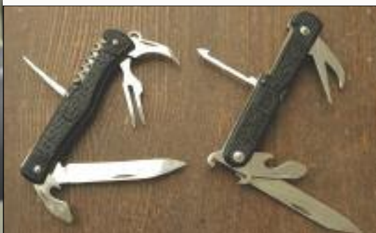
Обновление модельного ряда заводом «Сувенир» в середине 1980-х радости пользователям не принесло — переход на мягковатую нержавеющую сталь ухудшил функциональность ножей
