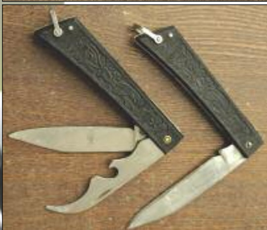
Обновление модельного ряда заводом «Сувенир» в середине 1980-х радости пользователям не принесло — переход на мягковатую нержавеющую сталь ухудшил функциональность ножей
