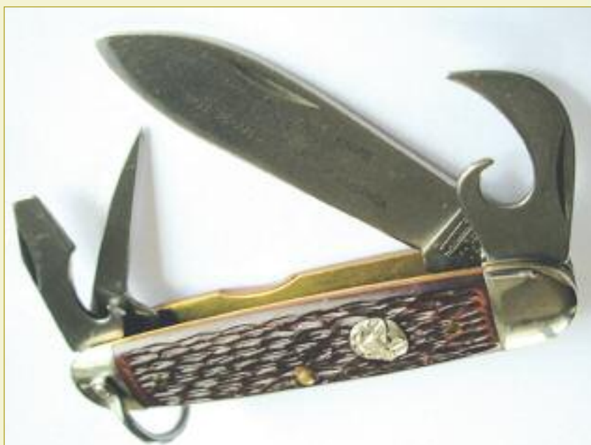
Характеристики MIL-K-818 (код производителя #1760): длина клинка 60 мм, длина в сложенном состоянии — 95,3 мм, ширина — 24 мм (по клинку), толщина — 12 мм, длина откинутой скобы — 16 мм, вес — 103 г
