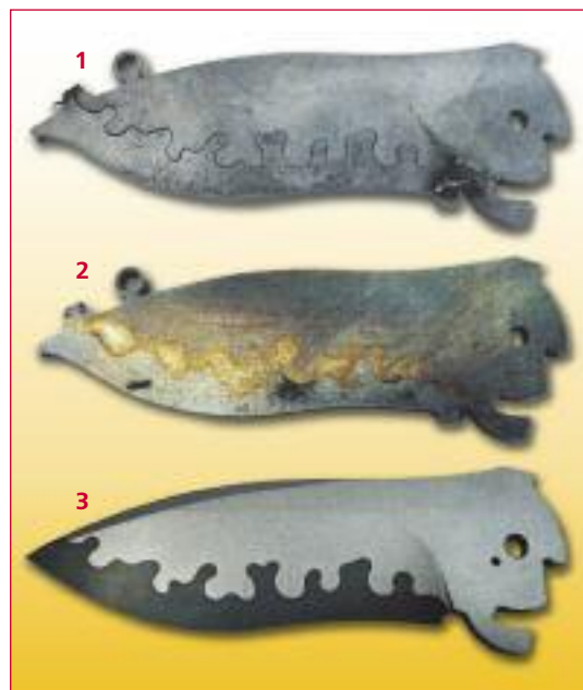
Технологические стадии производства клинка: 1 — сборка, 2 — пайка, 3 — шлифовка
