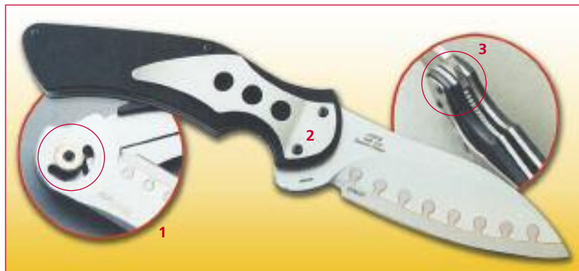
1 — бронзовые дистанционные шайбы значительно увеличивают срок эксплуатации изделия, 2 — большеразмерная клипса позволяет носить нож только в положении tip-down (хвостовиком вниз), 3 — стальной liner не оседает даже при сильных ударах по клинку
