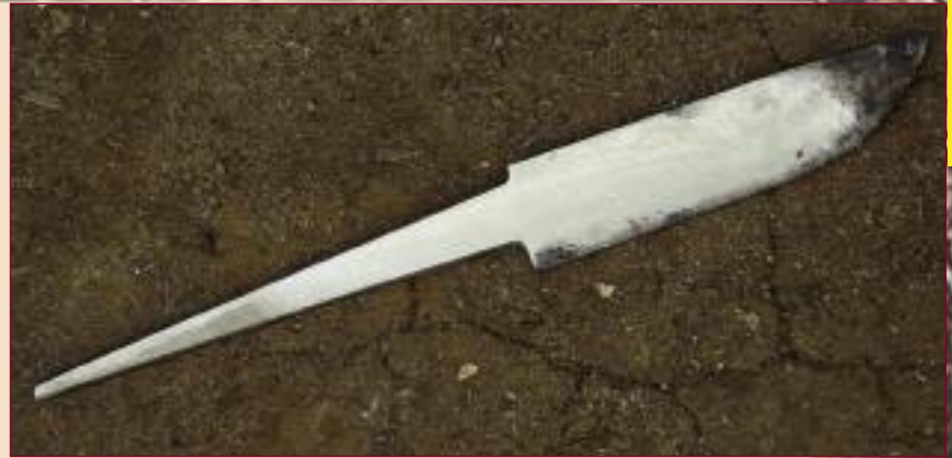
Выточенная по контуру форма клинка
