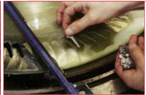
Подгонка делатей по толщине производится на барабанах
