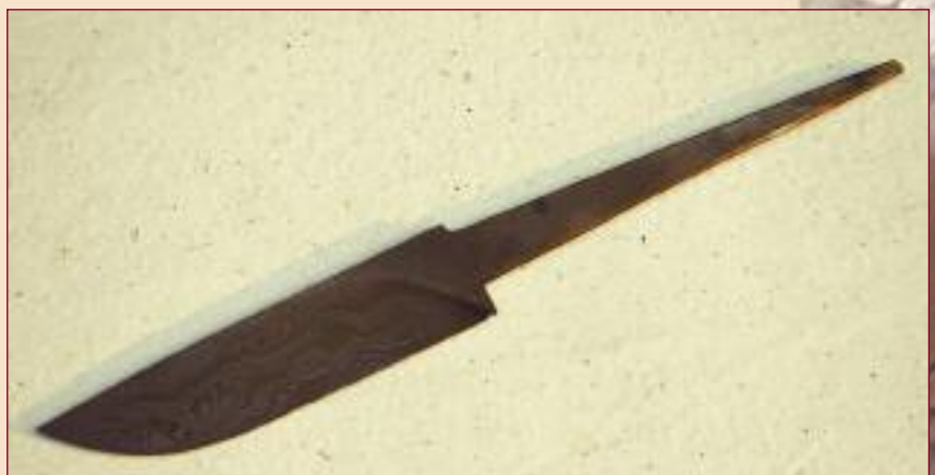
Клинок из дамаска после химического процесса
