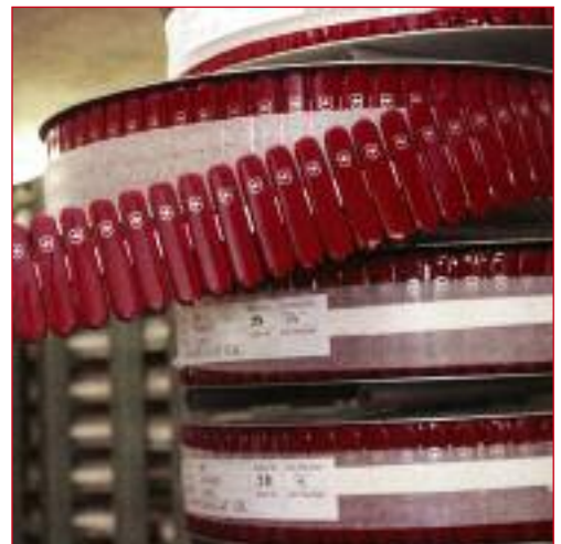
Детали поступают на конвейер из барабанов
