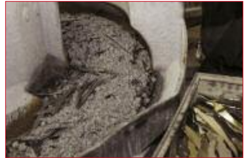
После закалки и отпуска заготовки полируют в молотом кукурузном зерне с абразивными добавками
