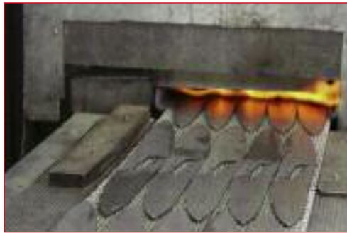
Нагрев под закалку в электропечи
