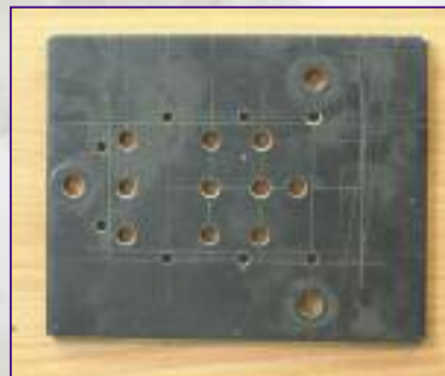
Сверлильный кондуктор, его нижняя часть сделана из дерева, верхняя — из стали
