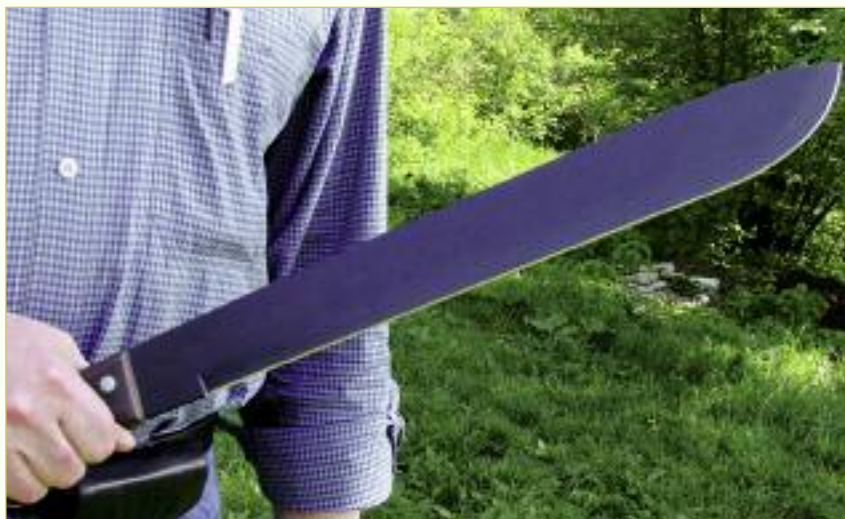
Мачете производства Linder имеют массивные клинки, что позволяет рубить ими растительность средних широт более сухую, чем в тропиках
