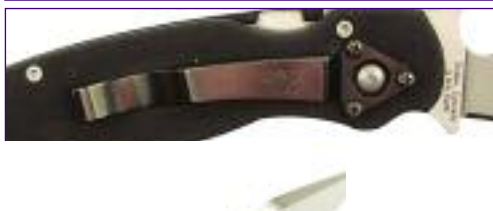
Нож Spyderco Paramilitary оснащен фиксатором типа Compression-Lock
