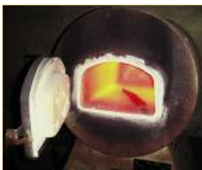
Нагревание клинка в печи для последующей закалки
