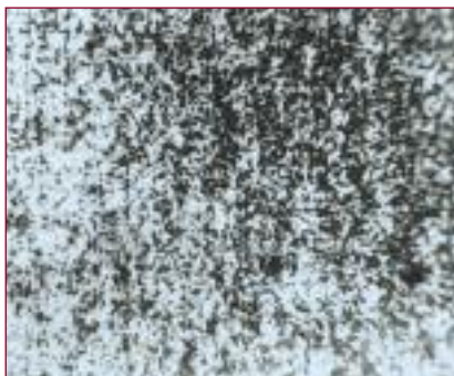
Малюнок 16 Гартування з 770°C, повздовжнє січення
