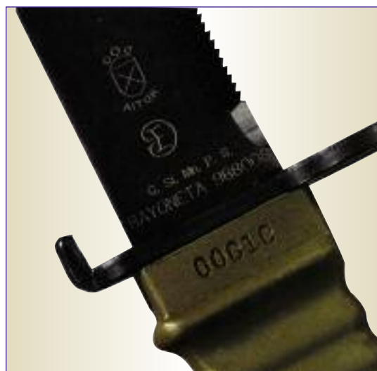
Маркировка штык-ножа коммерческого производства кроме логотипа производителя включает и логотип заказчика
