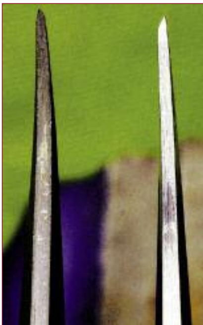
В результате испытаний острие ножа Cold Steel заметно изогнулось
