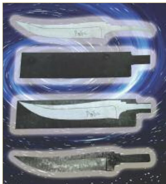
Последовательность операций изготовления клинка
