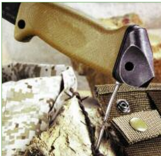
Навершие ножа может служить в качестве молотка, но для безопасного забивания гвоздей «острый предмет» следует держать в ножнах...
