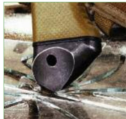
...Но его основным предназначением является разбивание остекления фонаря при аварии
