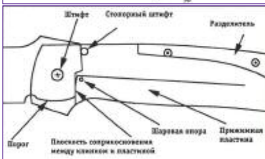
Схема фиксатора типа Liner-Lock
