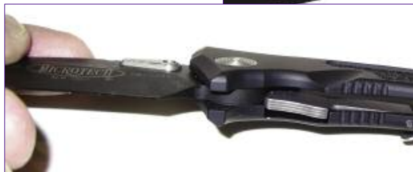
Нож Microtech Amphibian с фиксатором типа Microbar
