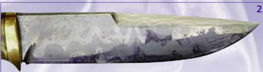
1, 2 — сварной булат (технология пакетирования)
