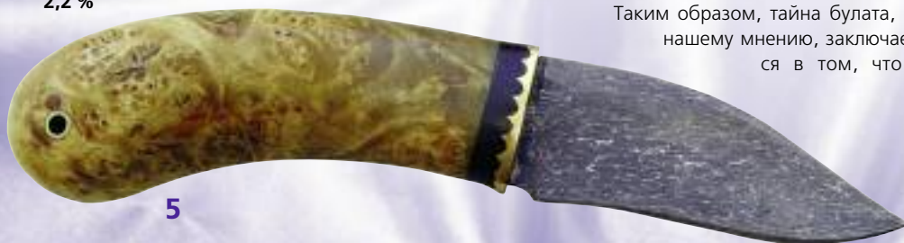
5 — литой булат, углерод — 2,2 %
