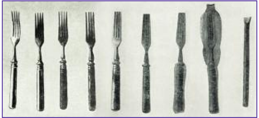
Последовательность производства т. н. одностальной вилки в павловской Кустарной артели
