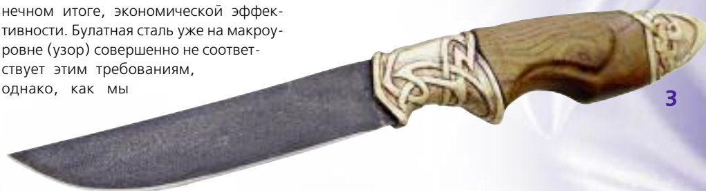
3 — литой булат, углерод — 1,57 %
