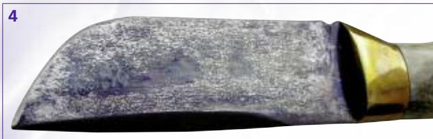
4 — литой булат, углерод — 2,55 % (фазовое состояние соответствует чугу-ну). С таким углеродом нож свободно строгает арматурное железо
