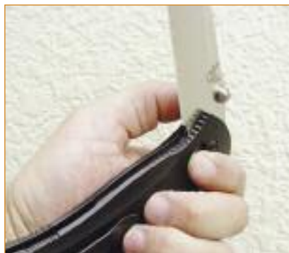
Действие механизма Rolling-Lock при раскладывании/складывании ножа
