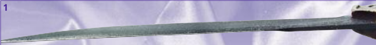
1, 2 — сварной булат (технология пакетирования)
