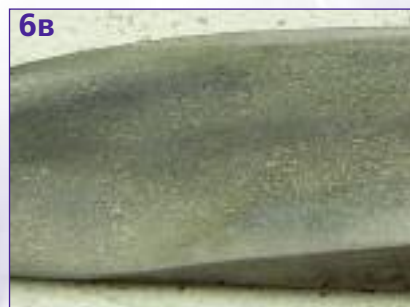
6 а, б, в — фрагменты булатных рисунков с содержанием углерода соответственно 1,85 %, 1,78 %, 1,73 %
