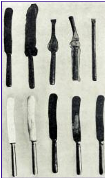
Последовательность производства т. н. одностального ножа в павловской Кустарной артели
