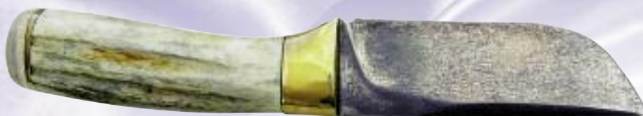
4 — литой булат, углерод — 2,55 % (фазовое состояние соответствует чугу-ну). С таким углеродом нож свободно строгает арматурное железо
