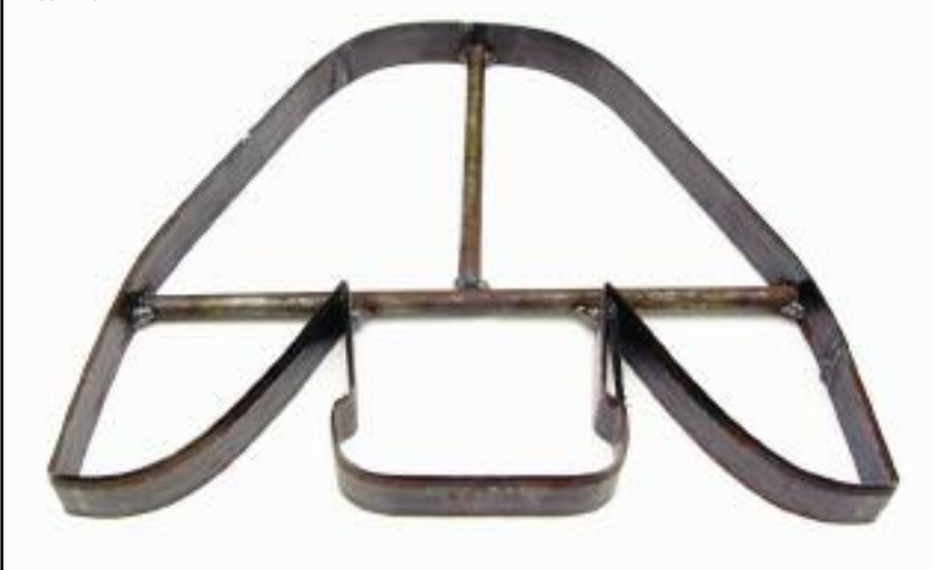
Штампи-різакі із шведської сталі. Такими різакми забезпечуються взуттєві фабрики
