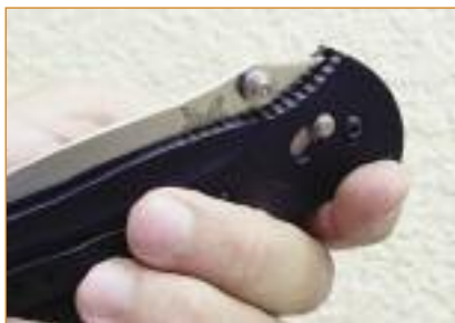
Действие механизма Rolling-Lock при раскладывании/складывании ножа
