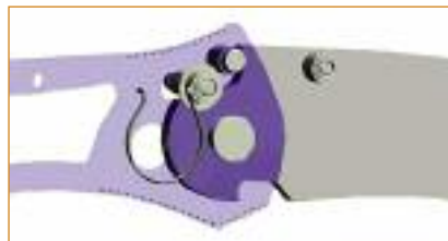
Механизм фиксации AXIS-Lock и схема его работы
