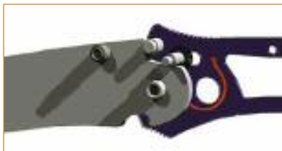
Механизм фиксации AXIS-Lock и схема его работы
