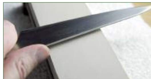
Ассиметричный профиль клинка обеспечивает удобство заточки/правки режущей кромки
