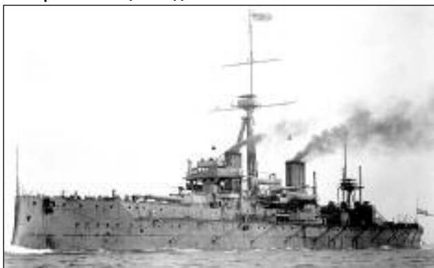
Британский дредноут 1906 г., оснащенный гарвеевской броней толщиной до 305 мм
