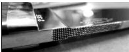
Некоторые рабочие ножи Лавлесса оснащались мелкой противоскользящей насечкой на обухе для удобства выполнения работ. Обращает на себя внимание значительная толщина клинка в обухе, что предполагает высокую прочность такого ножа
