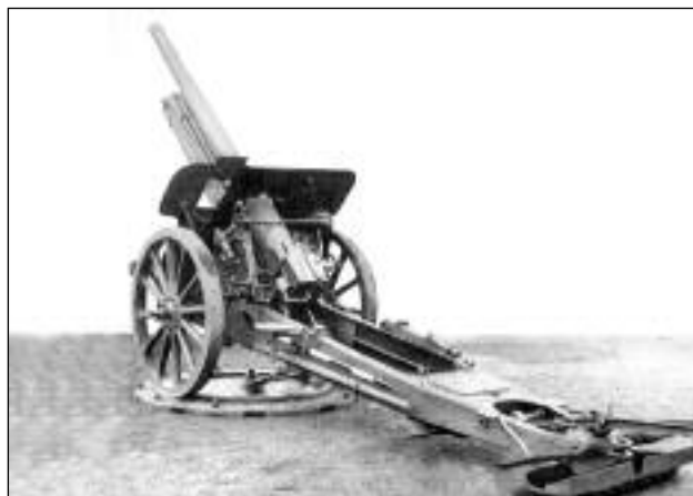
105-мм орудие Круппа М1914, имевшее практически двукратное превышение живучести ствола по сравнению с большинством орудий противников
