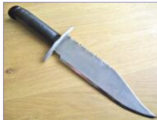
Самодельный нож «боуи», изготовленный из ножовочного полотна. На обухе оставлены полноценные «штатные» зубья, позволяющие при необходимости выполнить распил, однако направление их наклона выбрано неверно
