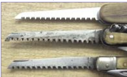
Фрагменты пил трех складных многопредметных ножей (снизу вверх): оригинального ножа Victoria, подделки под нож Victoria и современного ножа Victorinox. Наглядно прослеживается тенденция «перековки мечей на орала»
