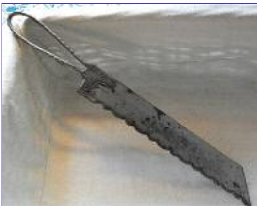
«Антикварный» хлебный нож с волнообразной заточкой РК — своеобразный прообраз современного серрейтора
