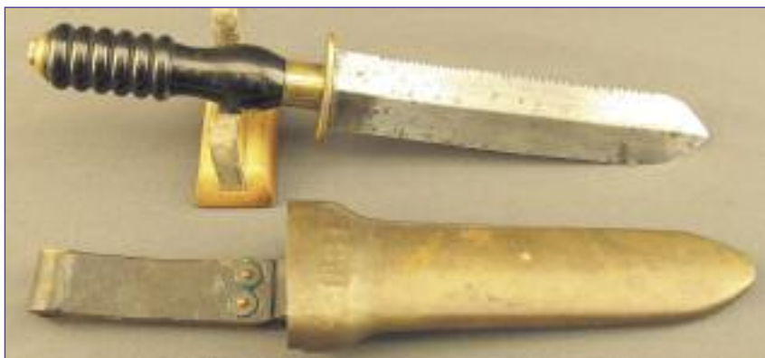
Нож глубинного водолаза по мотивам «официального» Mark V Dive Knife, состоявшего на вооружении с 1916 г. до конца 70-х гг. Такой двулезвийный нож являлся универсальным инструментом для работы под водой и мог использоваться не только в качестве ножа, но также молотка и пилы. Обладал высокой прочностью и долговечностью. Как видно на фото, пила имеет мелкие зубцы по всей длине одной из РК
