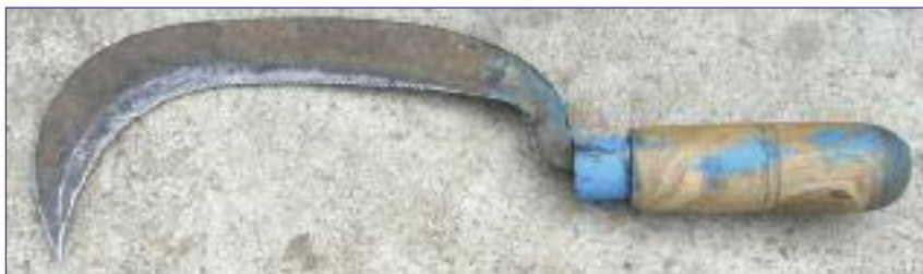
Серп, несмотря на свое мирное предназначение, является довольно эффективным режущим инструментом во многом благодаря мелко зазубренной внутренней кромке
