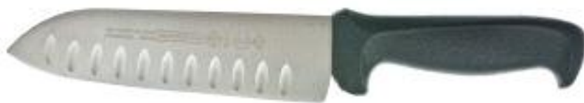
Подобные углубления на лезвиях ножей типа «Сантоку» издавна могут показаться каким-то «хитрым» серрейтором... На самом деле это технологические выемки, предназначенные для уменьшения прилипания нарезаемых продуктов к ножу
