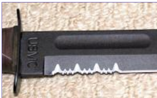
Внизу — фрагмент боевого ножа KA-BAR USMC (MkII) с комбинированной (полусеррейторной) заточкой. Наглядно видны отличия заточки KA-BAR от заточки SpyderEdge
