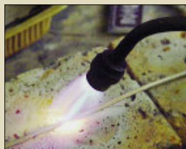
Отжиг серебряной проволоки перед очередным этапом вытяжки
