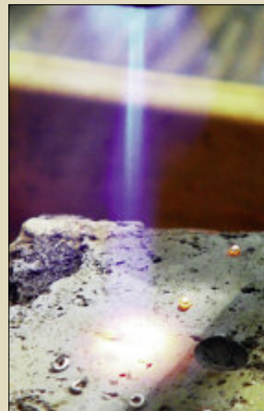
Серебряные кольца, плаваясь, превращаются в зернь
