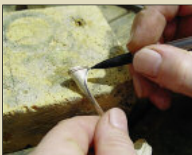
На серебряной обкладке прорисовываются контуры филигранных узоров
