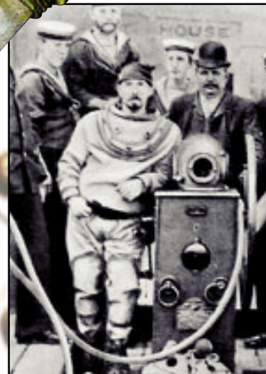
Фотография 1891 года. Снаряжение для погружений: скафандр, шлем, воздушная помпа и шланги
