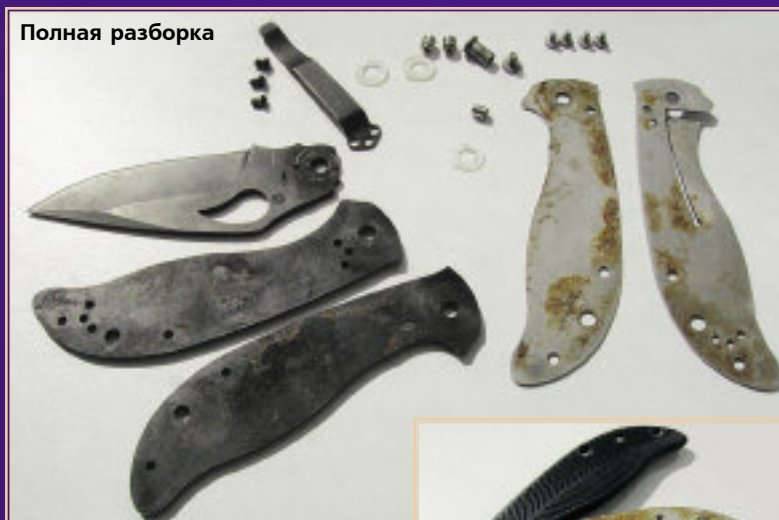
Основной очаг коррозии под накладками рукояти
