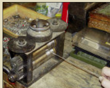
Вытягивание в вальцах серебряного прутка
