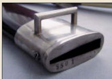
Фото 28. Устье ножен тесака TeNo со скобой и регистрационным номером на верхней кромке
