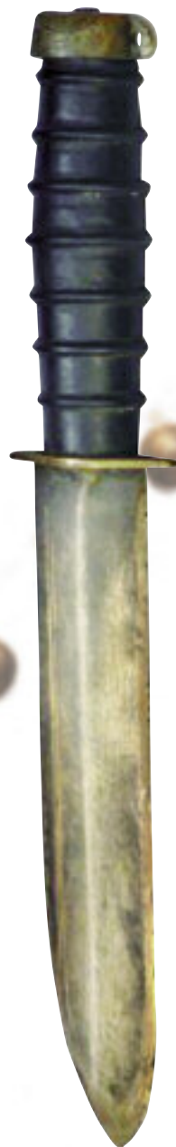
Модификация водолазного ножа «ВНВ» с немагнитным клинком
