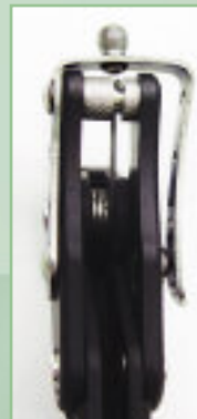
Фрагмент треугольного рычага с пружиной кручения, рифленной осью (с проточкой под длинный конец пружины) и клипсой со штифтом
