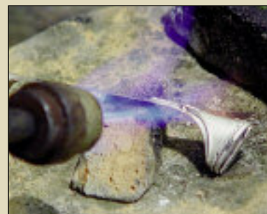
Напайка элементов филигрании на основу (обкладку рукояти)
