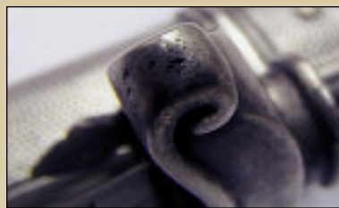
Фото 17. Дефект литья на конце крестовины поддельного кинжала TeNo
