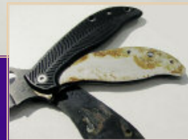
Основной очаг коррозии под накладками рукояти
