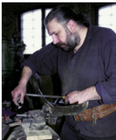
Класичним способом обробляється і доводиться лезо, шліфівкою та шабруванням вибираються доли, робиться струг на обушку клинка
