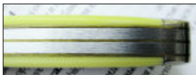
Зазор между латунным лайнером рукояти и пружиной клинка. «Camillus», США
