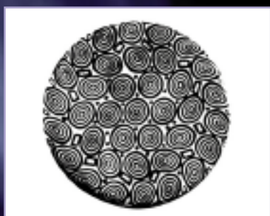
Торцевые срезы заготовок- прутков (сверху вниз): с параллельными слоями, концентрическими кольцами и в виде цветочного орнамента
