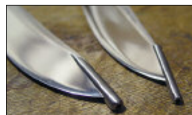
Варианты реализации ножа-распарывателя посредством присоединения к клинку насадки-«отупителя» (идея и работа автора)
