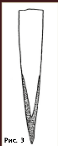
Схема наварки лезвия в обхват
