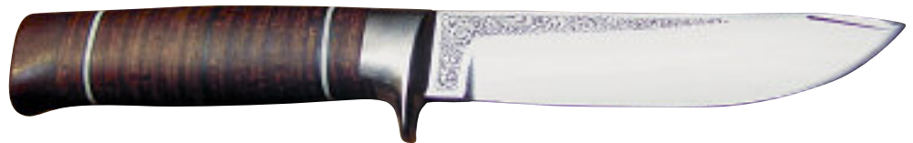
Вверху: охотничий нож общего назначения с небольшим односторонним упором. На острие клинка — пазы для присоединения насадки-«отупителя». Слева: рабочий эскиз ножа. Работа и рис. автора
