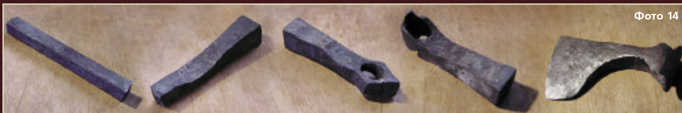
Последовательность изготовления цельнокованного топора
