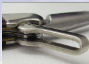
Антабка, выполняющая функцию рычага разблокировки фиксатора
