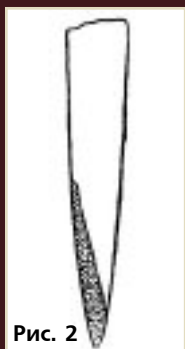
Схема боковой наварки лезвия
