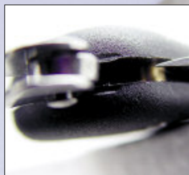
Следы выработки рукояти ножа от антабки
