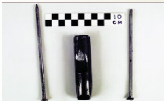
Пуансон для висадки головок цвяхів (див. п. 6. табл. 1)
