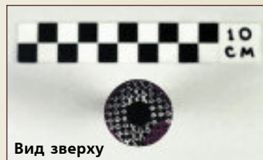
Шарошка для кошляння шкіри в місцях склеювання (див. п. 4. табл. 1)
