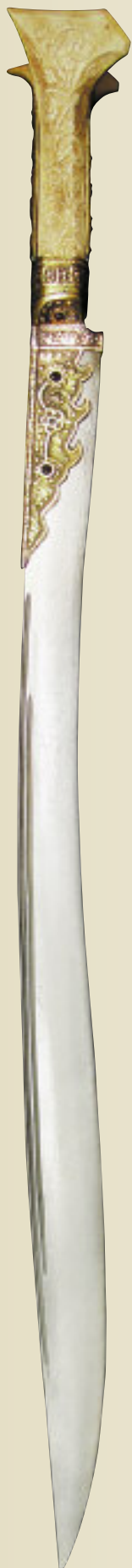
Мал. 8. Загальний вигляд та фрагмент клинка турецького ятагана з кількістю вуглецю 1,35% (коваль Я.Погоржельський, фото з архіву Редакції)
