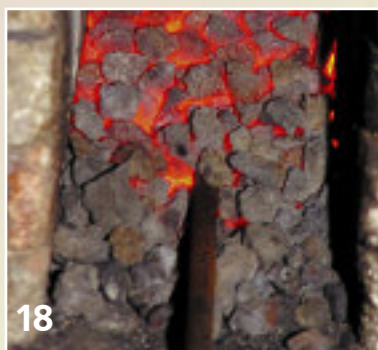
Фото 18. Нагрев пакета при выключенном дутье
