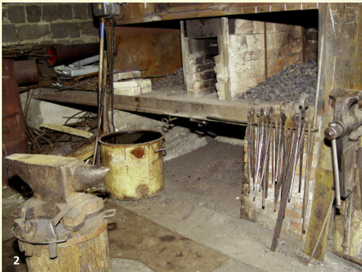
Фото 2. Горн, наковальня, бак с водой и инструменты, необходимые в кузне
