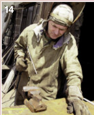
Фото 14. Сварка пакета с торцов
