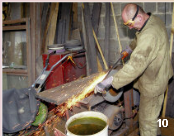
Фото 9. Нарезка полос металла режущим кругом
