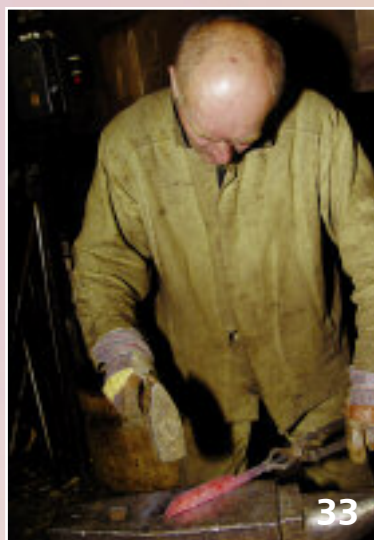
Фото 32. Дополнительная операция, проводимая с верхней и нижней плоскостями сваренного пакета
