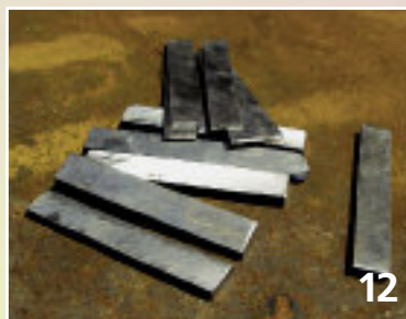
Фото 12. Пластины, приготовленные для сварки в пакет
