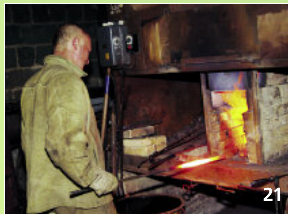
Фото 20. Кузнечная сварка пакета осуществляется вручную ручка
