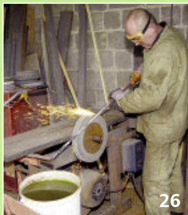
Фото 26. Шлифовка вытянутой полосы стали...
