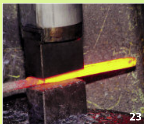
Фото 22-23 ...и вытягивание его в полосу пневматическим молотом
