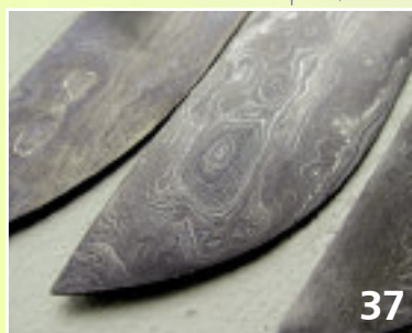
Фото 36–37 Увеличенные фрагменты дамасских клинков, демонстрирующие различный характер узора
