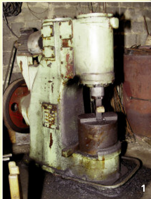
Фото 1. С использованием пневмомолота многие кузнечные работы упрощаются
