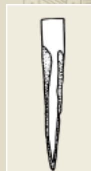
Илл. 9. Сварка в «обхват»
