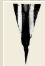
Илл. 8. Структура пятислойного ножа
