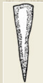
Илл. 2. Структура цементиро- ванного ножа
