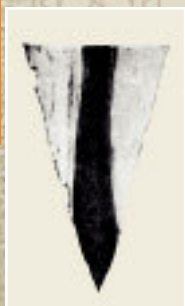
Илл. 26. Структура трехслойного ножа
