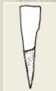
Илл. 15. Структура ножа, сваренного в «торец»
