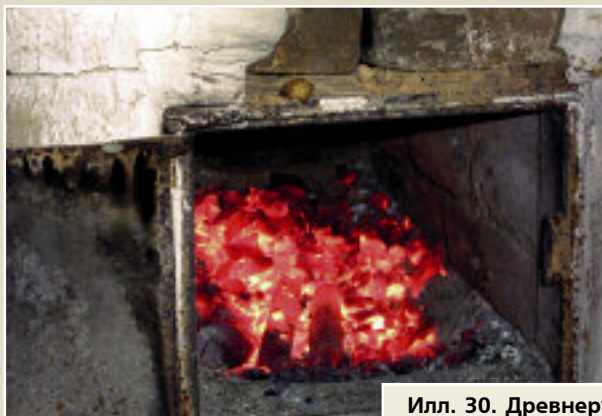
Илл. 29. Железные заготовки в топке дровяной печи, нагретые до 900 °C
