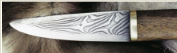
Илл. 23. Нож из дамасской стали, наваренный сталью в «торец». Работа автора
