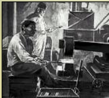
Отковывание клинков при помощи хвостового молота
