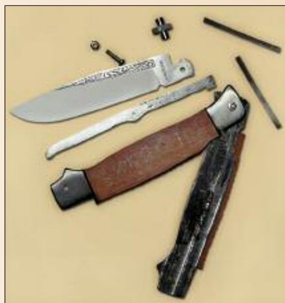
Заготовки, приспособления и различные фазы изготовления складного ножа
