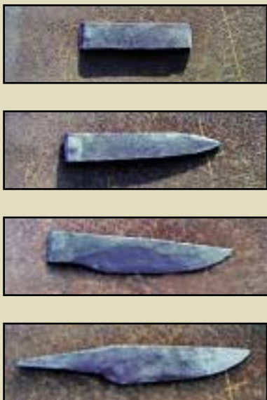
Фото 6. Последовательность ковки ножа
